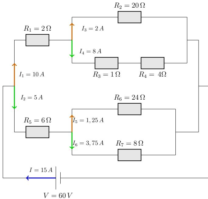
Trobem la resistència equivalent començant, per exemple, per  $R_3$  i  $R_4$  que es troben en sèrie
