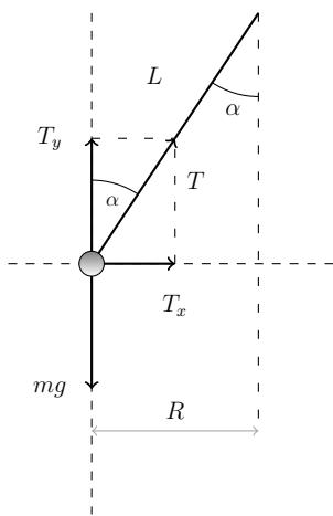
Després de posar uns eixos orientats d'acord amb el pes  $mg$ , veiem que la component vertical de la tensió equilibra al pes i la component horitzontal proporciona l'acceleració centrípeta,
