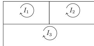
$$\begin{cases} -40 &= I_1 \cdot 20 + (I_1 - I_2) \cdot 30 + (I_1 - I_3) \cdot 10 \\ 60 + 20 &= I_2 \cdot 40 + (I_2 - I_1) \cdot 30 + (I_2 - I_3) \cdot 10 \\ 45 - 50 &= I_3 \cdot 25 + I_3 \cdot 15 + (I_3 - I_1) \cdot 10 + (I_3 - I_2) \cdot 10 \end{cases}$$
