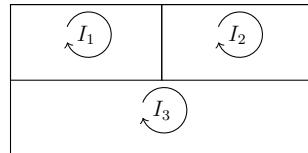
$$\begin{cases} -4 &= I_1 \cdot 2 + (I_1 - I_2) \cdot 3 + (I_1 - I_3) \\ 6 + 2 &= I_2 \cdot 4 + (I_2 - I_1) \cdot 3 + (I_2 - I_3) \\ 4,5 - 5 &= I_3 \cdot 2,5 + I_3 \cdot 1,5 + (I_3 - I_1) + (I_3 - I_2) \end{cases}$$
