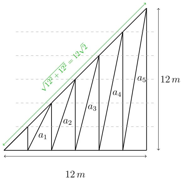
Hem de tenir en compte que la base queda dividida en 6 parts de longitud  $2\text{ m}$ , igual que l'alcada, ja que l'angle que forma la hipotenusa és de  $45^\circ$ . Respecte a les diagonals interiors de l'estructura
