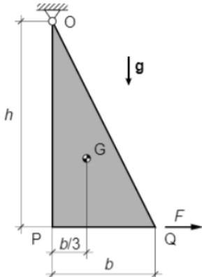
La placa d'alumini de la figura té un gruix  $e = 10 \text{ mm}$  i està penjada per l'articulació  $O$ . Per mantenir-la tal com s'indica a la figura s'estira per  $Q$  amb una força horitzontal  $F$ . Determineu:
