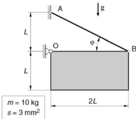
La placa de massa  $m = 10 \text{ kg}$  està articulada al punt O i es manté en repòs, mitjançant el tirant AB de secció  $s = 3 \text{ mm}^2$ , a la posició indicada a la figura. Determineu:
