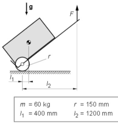
En un magatzem s'han de traslladar caixes en un carretó tal com s'indica a la figura. Si la massa del carretó és negligible i la de les caixes és  $m = 60 \text{ kg}$ ,
