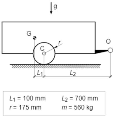
El remolc de la figura amb la càrrega inclosa té una massa  $m = 560 \text{ kg}$  i s'ha carregat de manera que el centre d'inèrcia (centre de masses) G del conjunt se situa a la posició indicada.
