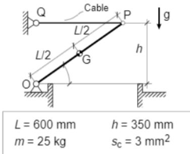
La tapa de la figura té una massa  $m = 25 \text{ kg}$  i està articulada a O. Per mantenir-la oberta es fa servir el cable PQ, de secció nominal  $s_c = 3 \text{ mm}^2$ , que es tensa fins que queda horitzontal. Determineu:
