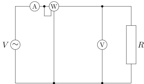
Noteu l'esquema de connexió d'un voltímetre, amperímetre i wattímetre al circuit. Al aplicar una tensió de la forma
