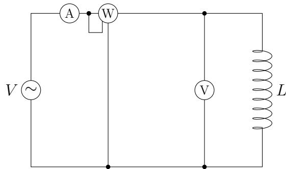
suposant que la bobina és ideal (no té resistència òhmica) s'observa que el wattímetre mesura una potència pràcticament nul·li que els valors de la intensitat són relativament limitats. La bobina ofereix una oposició al corrent elèctric de caràcter diferent a la de les resistències òhmiques. Això es deu a l'efecte d'autoinducció de la bobina que s'estudiarà al final de la segona avaluació a Física. La llei d'Ohm s'escriu
