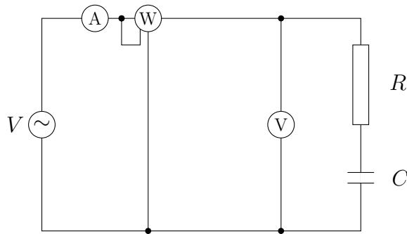
Suposeu que tenim una resistència  $R = 100 \Omega$  connectada en sèrie a un condensador  $C = 100 \mu F$  i que els sotmetem a una tensió alterna  $V = 10 V$ ,  $f = 50 Hz$ . Calculeu la intensitat que circula i la tensió que cau en cada element. Representeu la situació en un diagrama de fasors.
