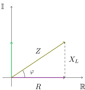
tenim el que s'anomena *triangle d'impedàncies* a partir del qual es pot construir el *triangle de tensions*
