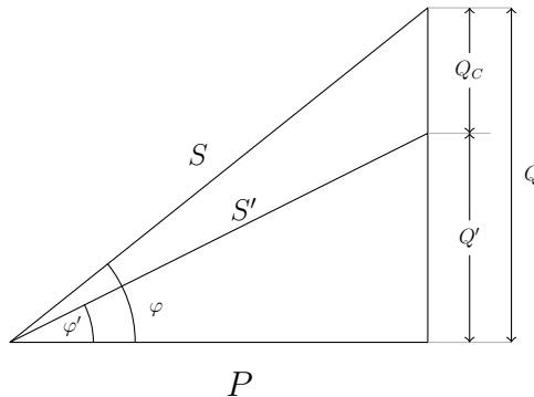
Amb  $\varphi$  l'angle inicial, es vol disminuir la potència reactiva (inductiva) inicial  $Q$  a un valor  $Q'$  que ve determinat per l'angle  $\varphi'$  necessari. Això permet calcular la potència reactiva (capacitiva) que haurem d'afegir per tal d'aconseguir el nostre objectiu. Tenim que ha de ser
