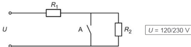
Una planxa de viatge pot funcionar connectada a la xarxa de tensió  $U_1 = 120\text{ V}$  i a la xarxa de tensió  $U_2 = 230\text{ V}$ . L'esquema elèctric de la planxa és el que es mostra en la figura. Quan funciona a 230 V, l'interruptor A està obert, i quan funciona a 120 V, l'interruptor A està tancat. La potència de la planxa és, en tots dos casos,  $P = 1\,000\text{ W}$ . Determineu:
