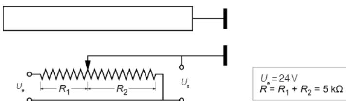
Per a mesurar una distància s'utilitza un potenciòmetre lineal com el que mostra la figura. El palpador móbil canvia el punt de mesurament del voltatge de sortida  $U_s$  i això fa que variin les resistències  $R_1$  i  $R_2$ . La suma de les resistències  $R = R_1 + R_2$  es manté constant i igual a  $R = 5 \text{ k}\Omega$ . Si el circuit s'alimenta amb una tensió  $U_e = 24 \text{ V}$ :
