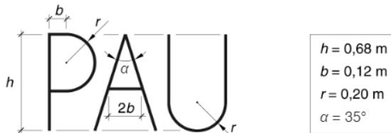
Un cartell lluminós està format per les lletres P, A i U, tal com mostra la figura, construïdes amb tub lluminós. El tub lluminós consumeix  $P_{\text{tub}} = 60 \text{ W/m}$  quan es connecta a la xarxa de tensió  $U = 230 \text{ V}$ . Determineu:
